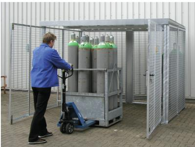
zur vorschriftengerechten Lagerung von Gasflaschen im Außenbereich. Oberfläche feuerverzinkt nach EN ISO 1461. Anlieferung erfolgt im Baukastensystem mit Aufbauanleitung zur Selbstmontage. Incl. Doppelflügeltür (2860 x 1985mm) BxH, mit Profilzylinder Abmessungen Container (außen) in mm: 3100 x 1500 x 2160 (L x B x H) Ausführung nach TRGS 510.
