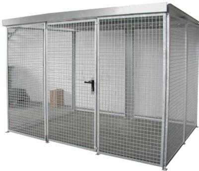
zur vorschriftengerechten Lagerung von Gasflaschen im Außenbereich. Oberfläche feuerverzinkt nach EN ISO 1461. Anlieferung erfolgt im Baukastensystem mit Aufbauanleitung zur Selbstmontage. Incl. Doppelflügeltür. Abmessungen (außen) in mm: 3100 x 2100 x 2180 (L x B x H) Ausführung nach TRGS 510.
