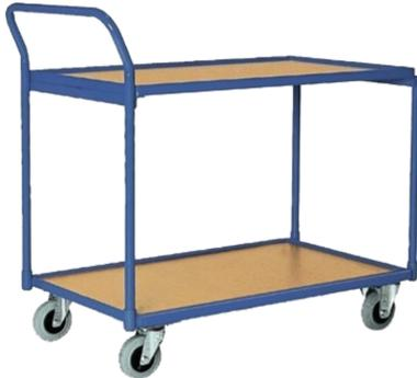
Tischwagen mit 2 Holzladeflächen im Winkelleistenrahmen, Tragkraft 250 kg, Ladefläche je 1000 x 600 mm, Ladehöhe 300 bzw. 800 mm, mit 2 Lenk- und 2 Bockrollen
