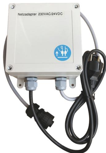
Inklusive 1,2 m Kabel zur Steuereinheit und 1,2 m Kabel zum Netzanschluß. Kabeleinführung von unten. Außenmaße ca. 130 x 130 x 75 mm (zzgl. Befestigungsglasche) Schutzklasse IP 67
