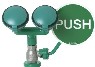
Kugelhahn aus Edelstahl, nicht selbstständig schließend. Bedienplatte aus Stahl, grün pulverbeschichtet. Medienführende Teile aus Messing. Inklusive Not-/Hinweisschild (Piktogramm). Wasserabgabemenge 14 l/min. bei 1,5 - 5 bar Fließdruck, inkl. automatischem Mengenregulator. Erforderlicher Wasseranschluß 1/2 Zoll Innen- gewinde. Prüfung: Gemäß BGI/GUV-I 850-0, DIN 1988, DIN EN 1717, ANSI Z358.1-2004, DIN EN 15154-2. DIN-DVGW geprüft und zugelassen.
