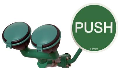
Kugelhahn aus Edelstahl, nicht selbstständig schließend. Bedienplatte aus Stahl, grün pulverbeschichtet. Medienführende Teile aus Messing. Inklusive Not-/Hinweisschild (Piktogramm). Sprühköpfe 45° abgewinkelt. Wasserabgabemenge 14 l/min. bei 1,5 - 5 bar Fließdruck, inkl. automatischem Mengenregulator. Erforderlicher Wasseranschluß 1/2 Zoll Innengewinde. Prüfung: Gemäß BGI/GUV-I 850-0, DIN 1988, DIN EN 1717, ANSI Z358.1-2004, DIN EN 15154-2. DIN-DVGW geprüft und zugelassen.
