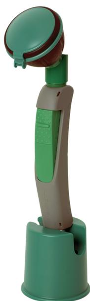
inkl. Stoßschutz und Staubschutzdeckel und Not-/Hinweisschild (Piktogramm). Brausekopf 45° abgewinkelt. Gehäuse aus glasfaserverstärktem Kunststoff. Medienführende Teile aus Messing. Wasserabgabemenge 7 l/min bei 1,5 - 5 bar Fließdruck, inkl. automatischem Mengenregulator und Rückflußverhinderer. Erforderlicher Wasseranschluß 1/2 Zoll Außengewinde. Schlauchlänge 1500 mm. Prüfung: Gemäß BGI/GUV-I 850-0, DIN 1988, DIN EN 1717, ANSI Z358.1-2004, DIN EN 15154-2. DIN-DVGW geprüft und zugelassen.
