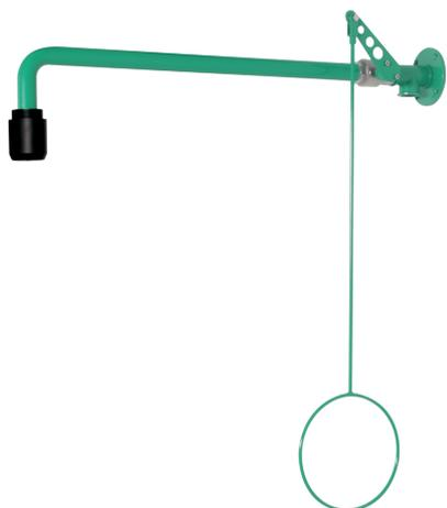
Duscharm aus Messing, grün pulverbe- schichtet. Kugelhahn aus Edelstahl. Hochleistungsduschkopf aus chemikalienbe- ständigem Kunststoff, selbstentleerend. Inklusive Not- /Hinweisschild (Piktogramm). Wasserabgabemenge 50 l/min. bei 1,5 - 3 bar Fließdruck, inkl. automatischem Mengenregulator. Erforderlicher Wasseranschluß 3/4 Zoll Außen- gewinde. Prüfung: Gemäß BGI/GUV-I 850-0, DIN 1988, DIN EN 1717, ANSI Z358.1-2004, DIN EN 15154-1. DIN-DVGW geprüft und zugelassen.
