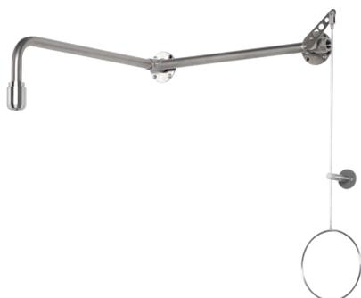
Verrohrung, Duscharm, Kugelhahn und Zug- stange aus Edelstahl. Hochleistungsduschkopf aus Edelstahl, selbstentleerend. Inklusive Not-/Hinweisschild (Piktogramm). Wasserabgabemenge 50 l/min. bei 1,5 - 3 bar Fließdruck, inkl. automatischem Mengenregulator. Erforderlicher Wasseranschluß 3/4 Zoll Innen- gewinde. Prüfung: Gemäß BGI/GUV-I 850-0, DIN 1988, DIN EN 1717, ANSI Z358.1-2004, DIN EN 15154-1. DIN-DVGW geprüft und zugelassen.
